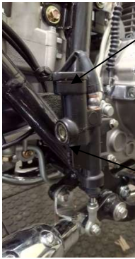
Schalter Bremslicht hinten Kontrollfenster für Bremsflüssigkeit
